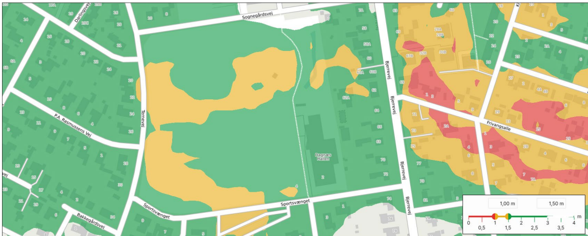
Figur X3 – Grundvandspejl i vintersituationen (HIP via Scalgo).
